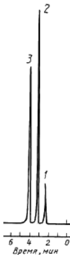
1 — сероводород; 2 — метилмеркаптан; 3 — этилмеркаптан
